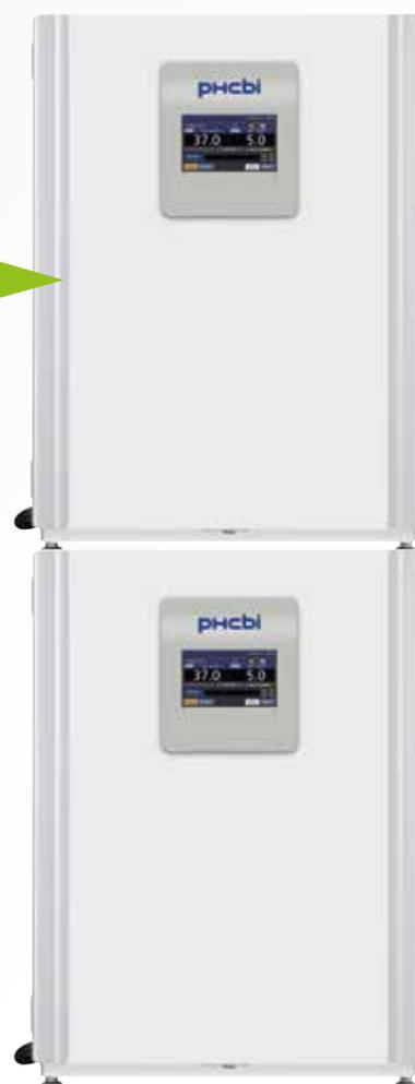
Para evitar quemaduras durante el ciclo de esterilización con calor, la puerta exterior se bloquea electrónicamente. La temperatura de la superficie superior del MCO-170AICD durante la esterilización por calor es de aproximadamente 60 °C. 60 °C está dentro de la tolerancia descrita en la norma internacional de seguridad IEC 61010 10.1: Límites de temperatura de la superficie para la protección contra las quemaduras. El límite de seguridad para el metal externo es de 65 °C.
