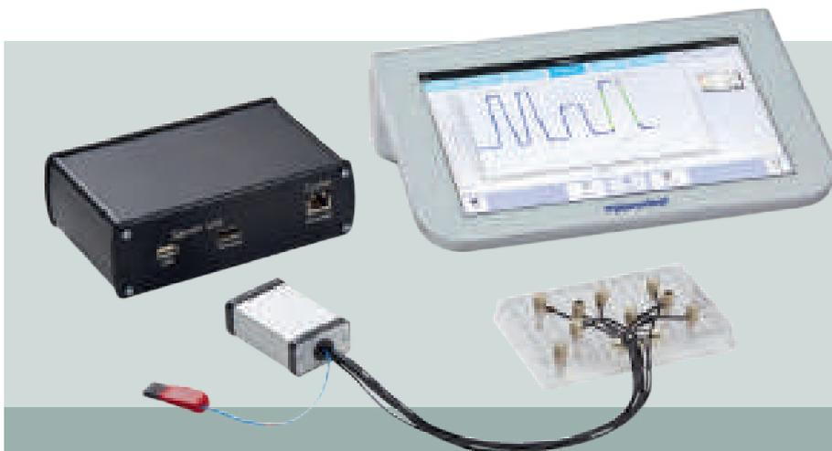
La verificación de temperatura con un sistema de múltiples sondas permite una evaluación rápida y fiable del rendimiento del termociclador. Los certificados generados pueden apoyar la cualificación de instrumentos para su sistema de gestión de calidad.
