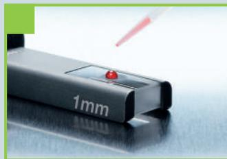
**El toque final:** recubrimiento superficial hidrofóbico sobre vidrio de cuarzo
